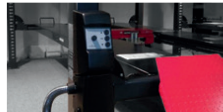
Contrôle et groupe hydraulique sur la colonne arrière de gauche
