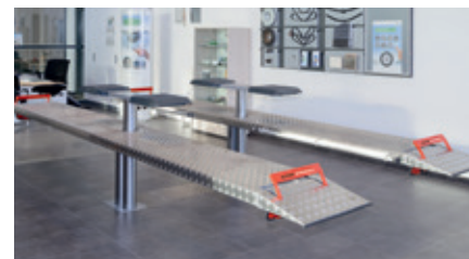
Pont élévateur dans la réception
