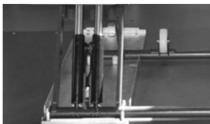
Système à doubles-vérins, pas d'air comprimé nécessaire
