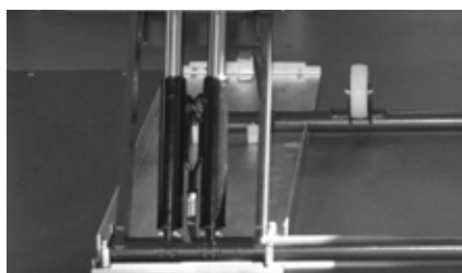
Système à doubles-vérins, pas d'air comprimé nécessaire
